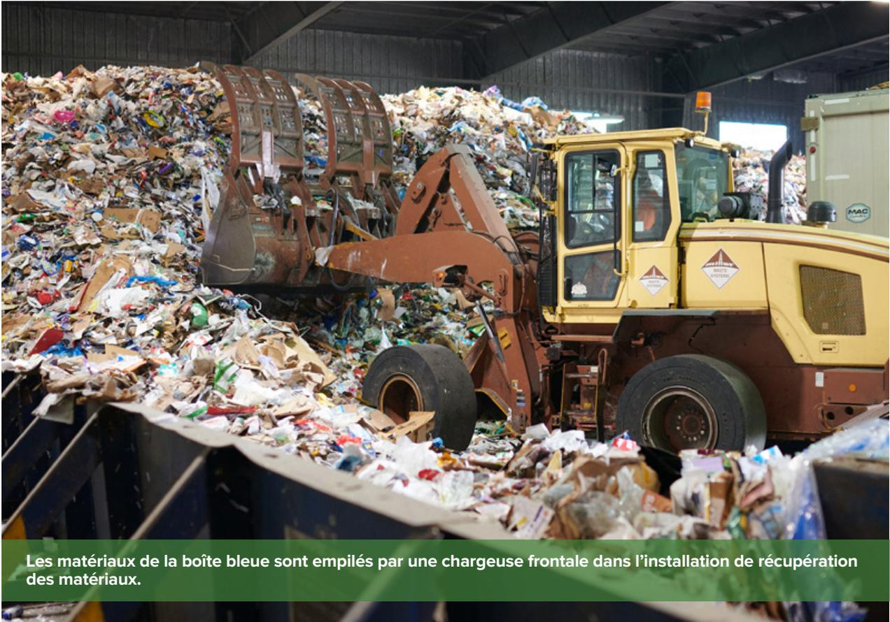
Les matériaux de la boîte bleue sont empilés par une chargeuse frontale dans l'installation de récupération des matériaux.
